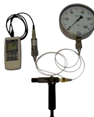
Пример применения, проверка манометра при помощи калибратора CPH6200 и пневматического ручного насоса CPP7
