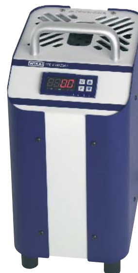
Сухоблочный калибратор температуры CTD9100-ZERO
