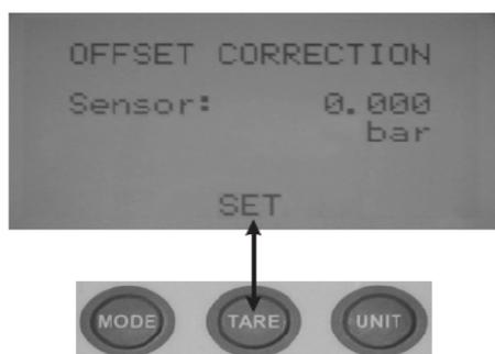
Корректировка нуля производится для модуля избыточного давления, присоединенного к прибору, и который не находится под давлением (сообщается с
