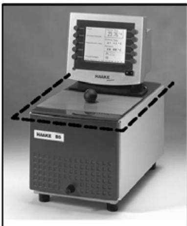
**!** Многие части прибора при его работе подвержены нагреву – риск ожогов! Температура отмеченной зоны (на рисунке) становится выше 70°C если температура в ванне составляет 200°C. Примите необходимые меры предосторожности.
