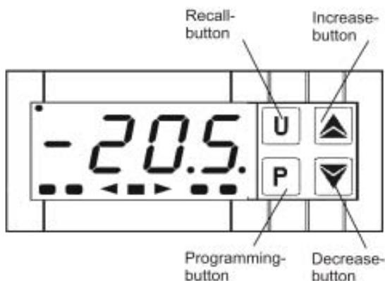
Контроллер прибора настраивается на режим при помощи 4 кнопок:
