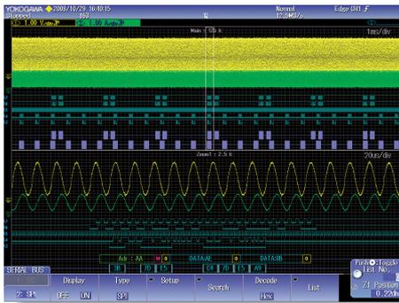
Одновременный анализ I<sup>2</sup>C и SPI
