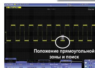
Поиск форм сигнала, которые пересекали / не пересекали прямоугольную зону, помещенную на экране.
