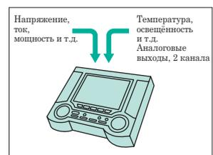
Кроме адаптера переменного тока можно использовать никель-металлогидридную аккумуляторную батарею (94004) или щелочные батареи (шесть батарей AA). Анализатор качества электроэнергии CW240 будет продолжать работать даже после прекращения подачи электропитания.
